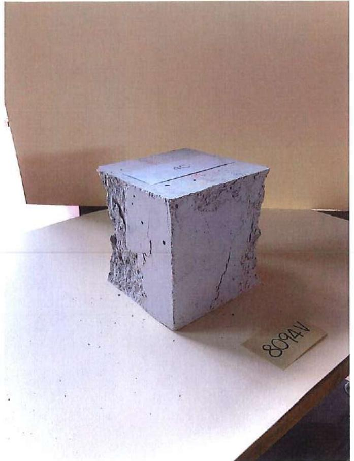
Fig.12 - Provino n.4 rottura
