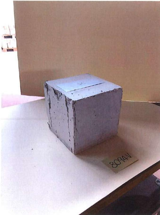
Fig.15 - Provino n.5 rottura
